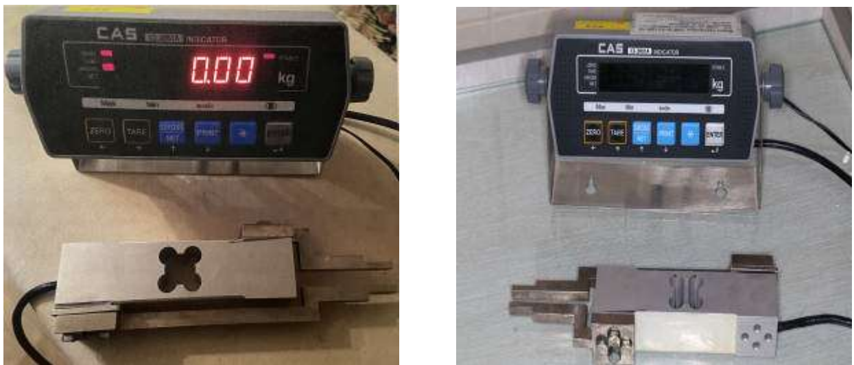
Рис. 2.5 ( а, б) Фото електронних платформних вагів «Hercules».
