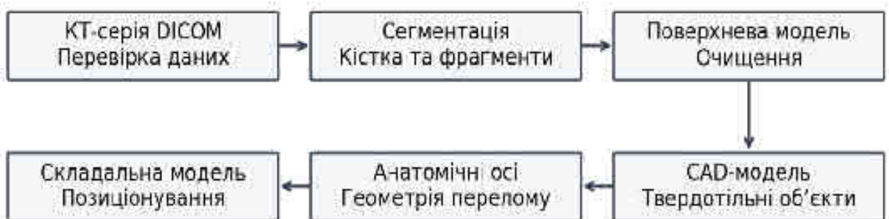
Рис. 4.1. Послідовність підготовки геометричної моделі за КТ-даними
