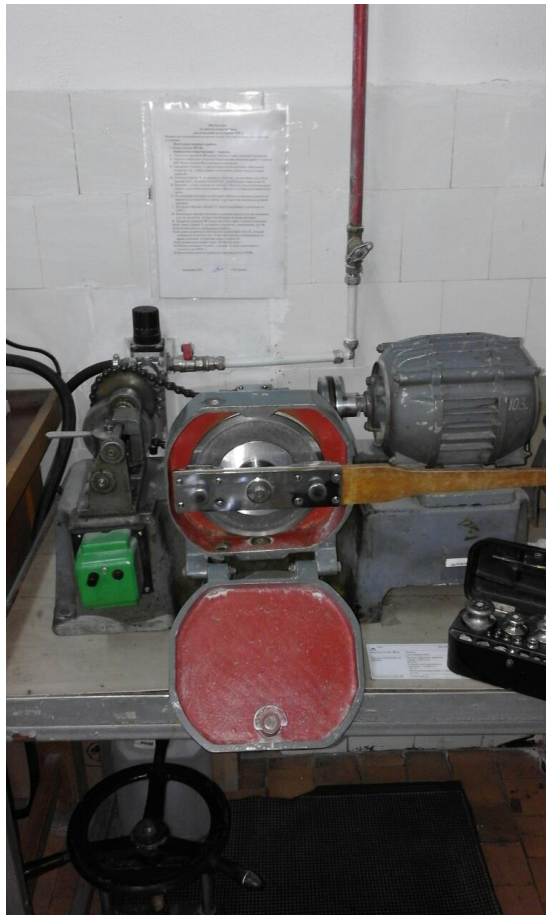
Рис.2.2.4 Випробовування зразку на опір стиранню
