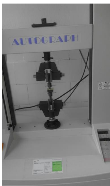
Рис. 2.2.2 Випробування межі міцності на відрив
