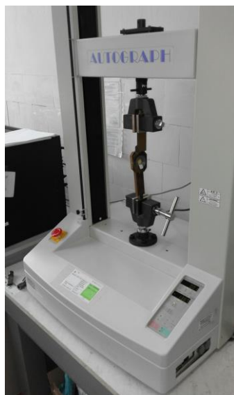
Рис. 2.2.3 Випробування зразка на опір зсуву
