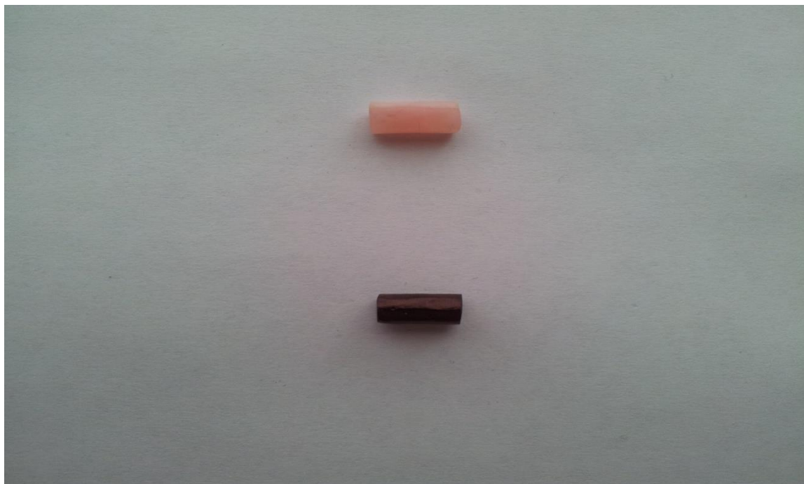
Рис.2.2. Зразки для визначення деформації на стиск
