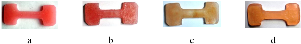
Рис. 2.7 Зразки матеріалів для вивчення їх на розтяг (a – «Фторакс»; b – «Vertex ThermoSens»; c – «Deflex Acrylato»; d – «Ліпол»)
