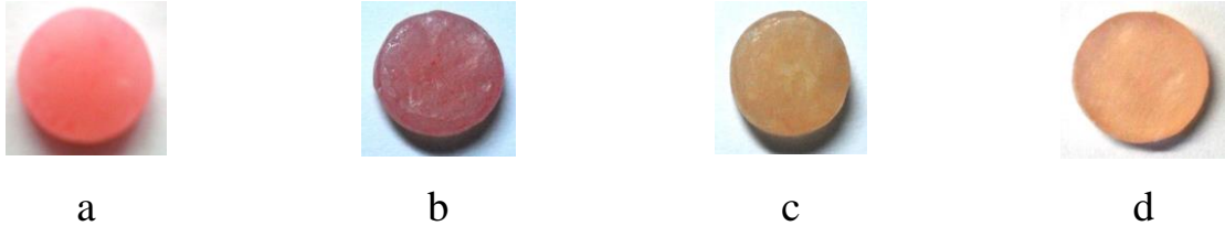
Рис. 2.6 Зразки матеріалів для вивчення мікротвердість (a – «Фторакс»; b – «Vertex ThermoSens»; c – «Deflex Acrylato»; d – «Ліпол»)
