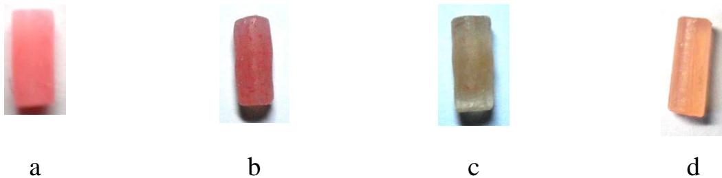
Рис. 2.8 Зразки матеріалів для вивчення їх на стиск (a – «Фторакс»; b – «Vertex ThermoSens»; c – «Deflex Acrylato»; d – «Ліпол»)
