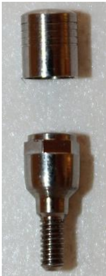
Рис. 2.1 Фотографічне зображення стоматологічного магнітного абатмента власної конструкції
