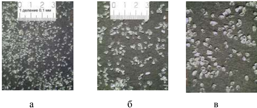
Рис. 2.7 Частки електрокорунда: а – електрокорунд F 120; б – електрокорунд F 80; в – електрокорунд F 60.
