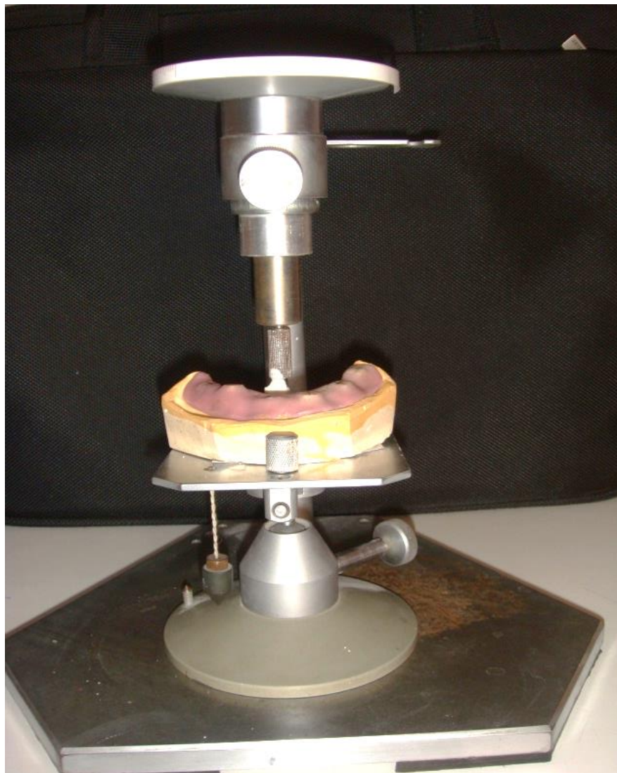
Рис. 4.14 Вигляд моделі загіпсованої в «нульовому» положенні.
