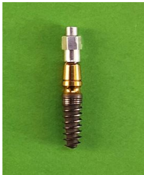
Рис. 2.5 Зовнішній вигляд дентального імплантату із зафіксованим на ньому датчиком Smart Peg.
