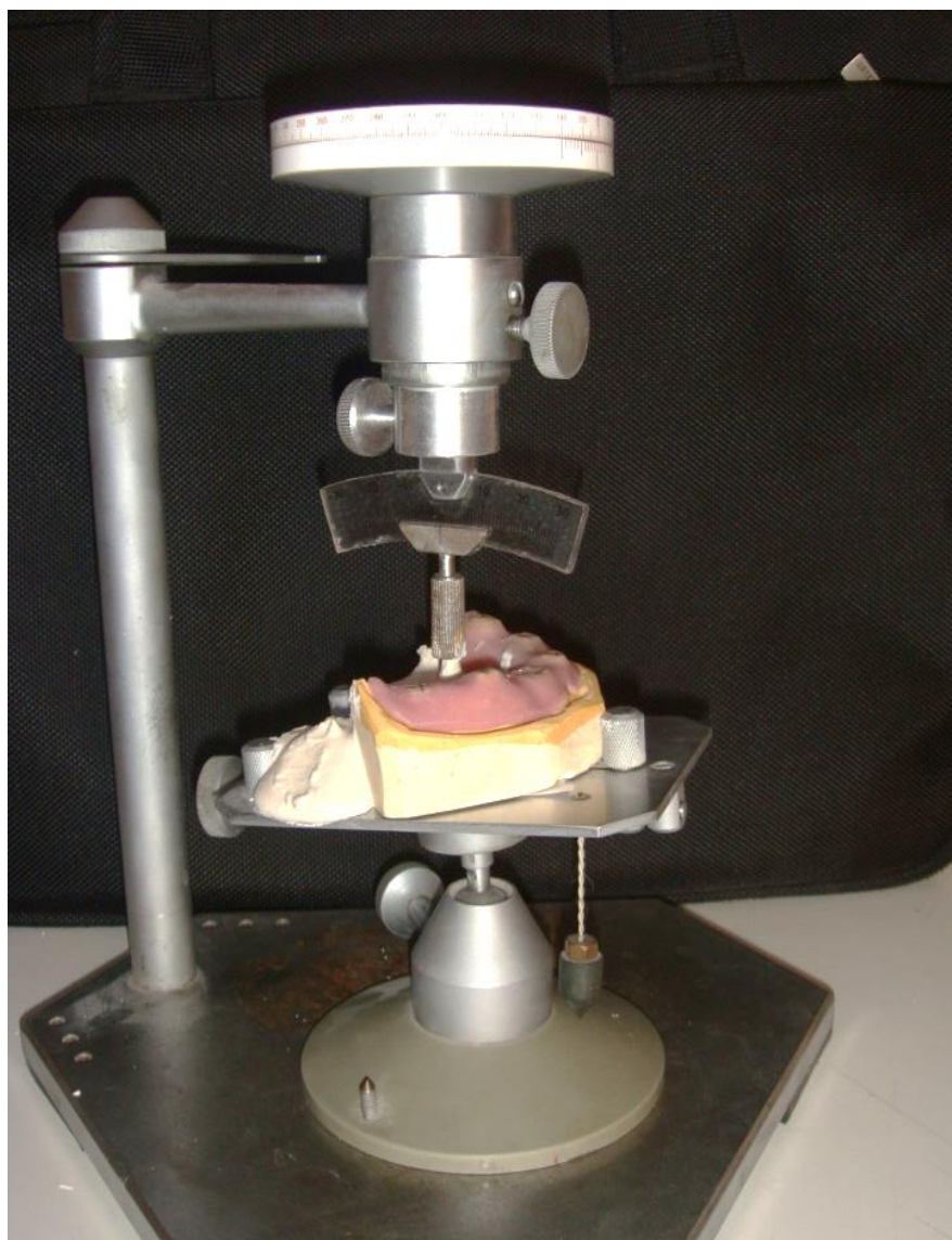
Рис. 4.15 Етап визначення кута нахилу моделі відносно горизонтальної площини з допомогою пристрою для позиціонування.
