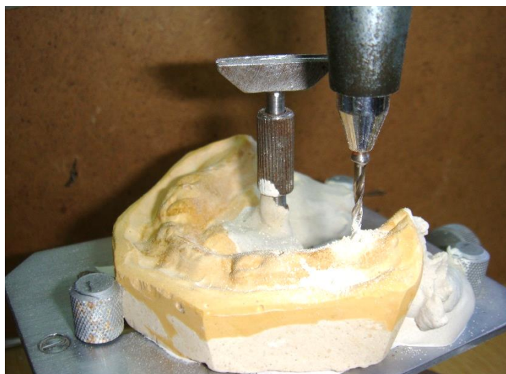
Рис. 4.17 Етап свердління направляючого отвору в моделі.
